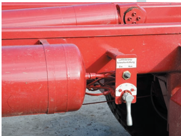
Der Drehknopf oben ist für Aktivierung/Deaktivierung der automatischen Entlüftung, mit dem Handventil darunter lässt sich das Fahrzeug „hochpumpen“ und „absenken“. Schade, dass man nur dem Handventil eine dauerhafte Markierung spendiert hat.
