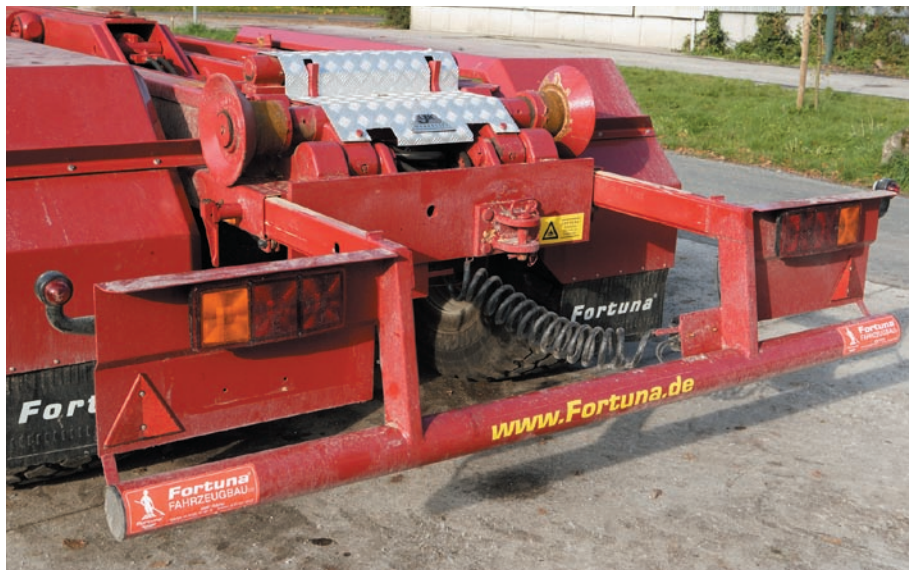
Bequem herauszuziehen und mit einer ordentlichen Beleuchtung versehen: der Unterfahrerschutz des Fortuna FTH 200.
