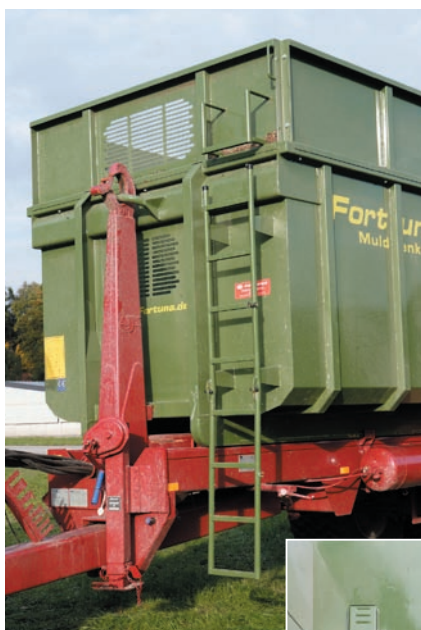
Dank klappbarer Leiter und Innentritte gelangt man bequem in den Container. Das untere Sichtfenster wird komplett vom Haken verdeckt.
