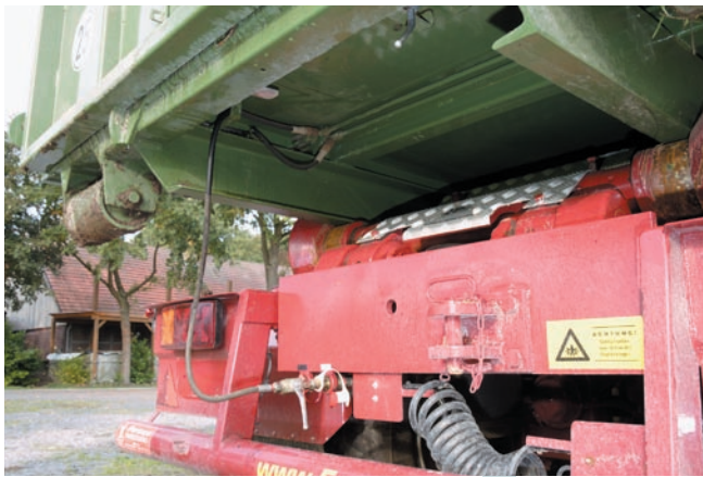
Die Rangierkupplung ist um 18 cm nach rechts versetzt. Noch nicht zufriedengestellt hat uns die Halterung für die Ölschläuche der Heckklappe unter dem Container.
