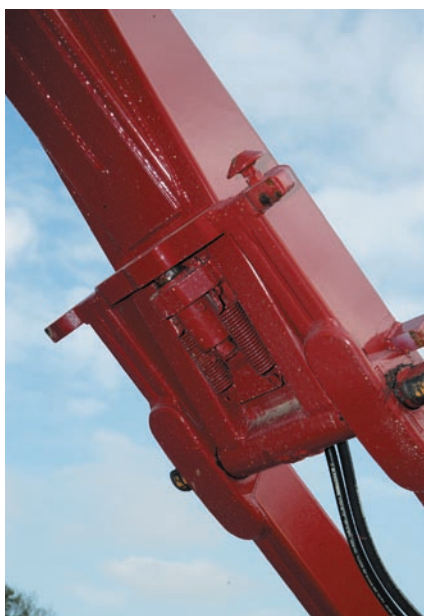
In der hintersten Position löst der Schubarm die Arretierung, und die Anlage kann für den Containerwechsel einknicken.
