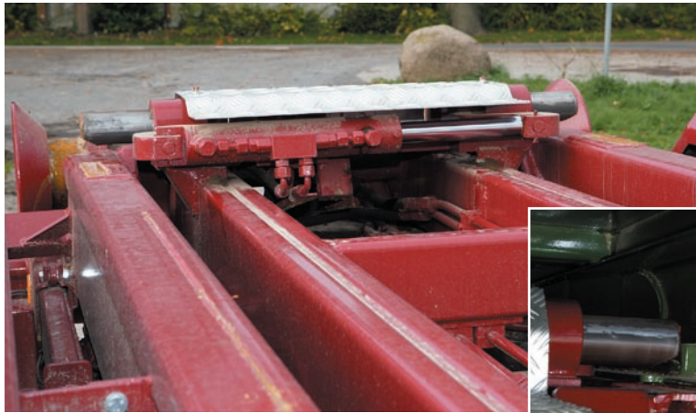
Die Containerverriegelung fuhr beim getesteten FTH 200 für fremde Container nicht weit genug auseinander. Dieses Problem wurde laut Fortuna inzwischen abgestellt.
