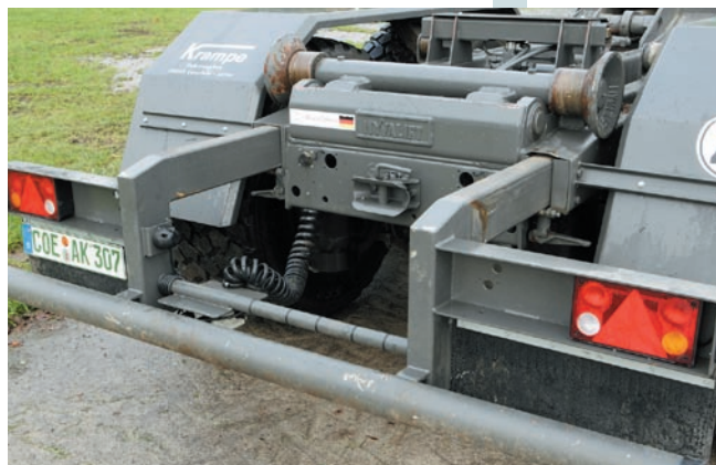
Zum Herausziehen des Unterfahrerschutzes ist der Kraftaufwand zu hoch (auf Wunsch hydraulisch). Außerdem ist die Aufnahme der Unterfahrerschutz-Längsholme nicht stabil genug.
