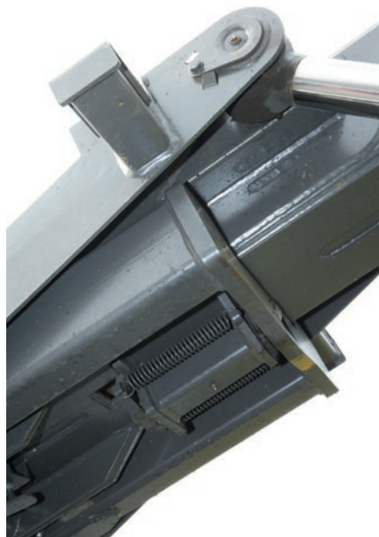
Fährt der Schubarm in die hinterste Position, entriegelt der Bolzen, und die Brücke kann zum Containerwechsel einknicken.
