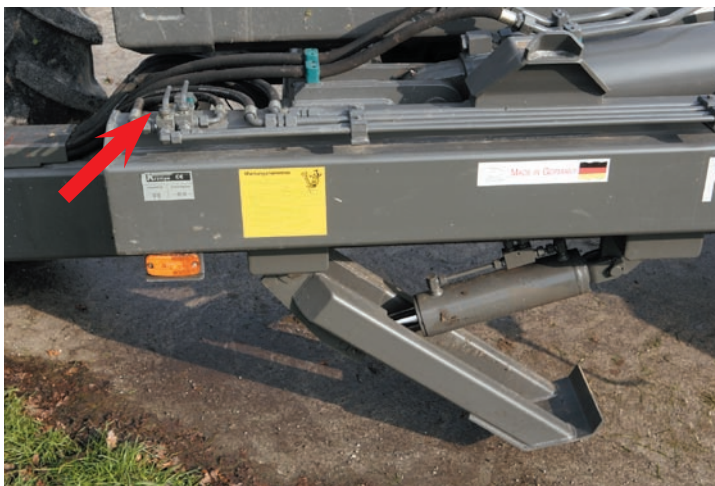
Nach dem Umlegen der beiden Dreiwegehähne (Pfeil) wird der hydraulische Stützfuß sehr komfortabel betätigt.
