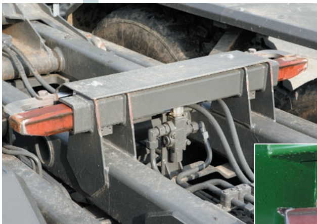
Beim maximalen Bolzenabstand lag die Containerverriegelung deutlich vorne. Das Versteifungsblech im Containerrahmen (rechts) verhinderte leider ein Verschieben zur Anpassung der Stütz- und Achslast.
